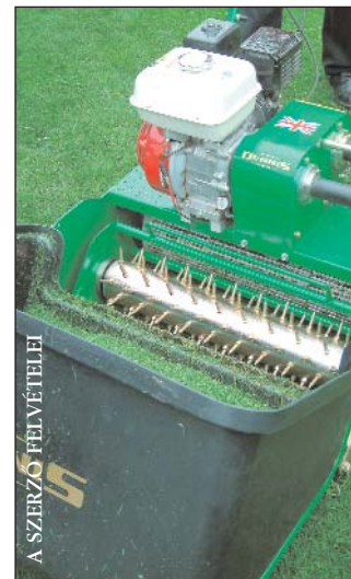
▲ A henger tüskéi a talajba fúródna, ez segíti a levegő, a víz és a tápanyag gyökérszónába jutását
